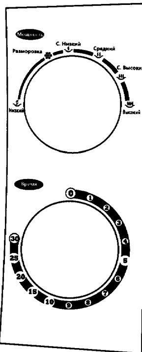
Панель состоит из двух ручек управления. Одна из них является ручкой управления таймером, а другая - для мощности.
